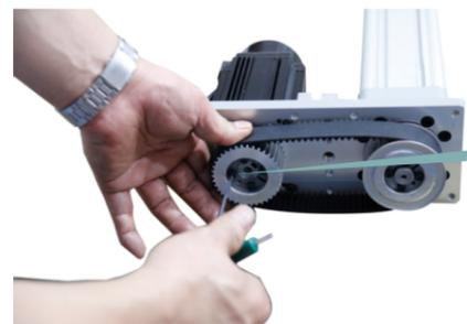
张紧套螺丝一定要锁紧，两皮带轮应使皮带保持平衡。
