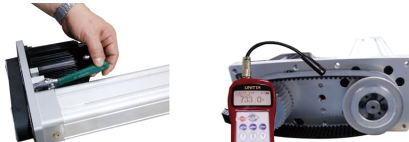
注：在调节张紧机构时应使用张力测试仪参照相对应的参数标准进行调节。
